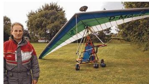
Nicht viel dran an dem Ultraleicht-Trike von Willi Hübscher: An einem Drachen hängt ein Sitz mit Rollen und Motor.
