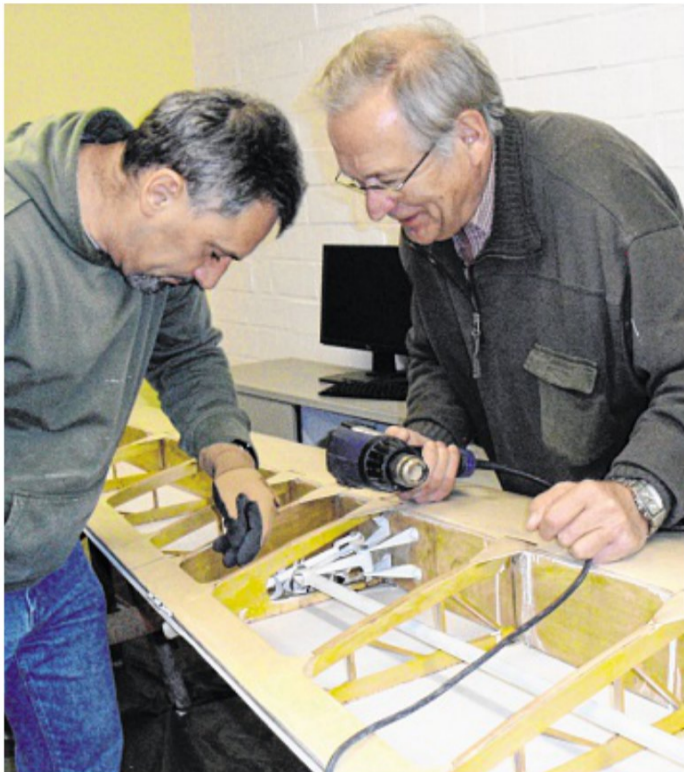
Christian Langenau und Gunnar Schreiber arbeiten die Bespannung am Querruder-Beschlag vorsichtig mit Heißluft nach, bevor die Oberseite der Tragfläche bespannt und der Flügel damit verschlossen wird.
